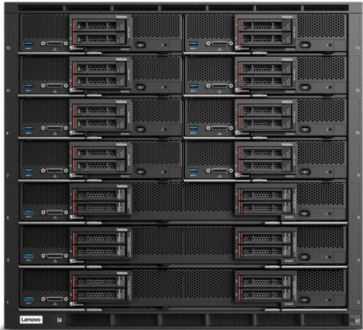
O Flex System Enterprise Chassis acomoda até 14 nós de processamento SN550, entregando alta densidade.
