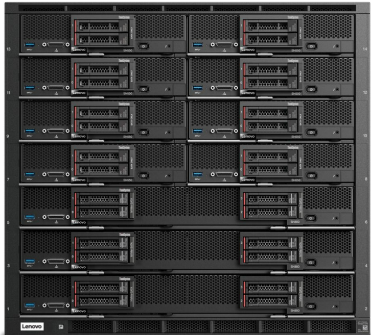
O chassi Flex System Enterprise acomoda até sete nós de processamento SN850, proporcionando alta densidade.
