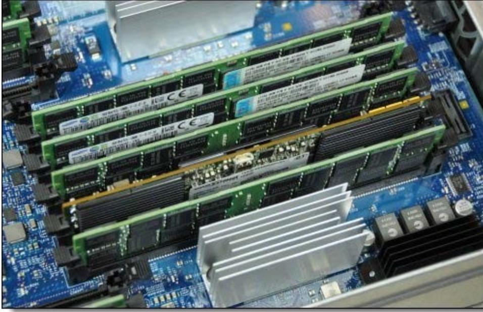
图 5：安装在计算模块中的 eXFlash DIMM
