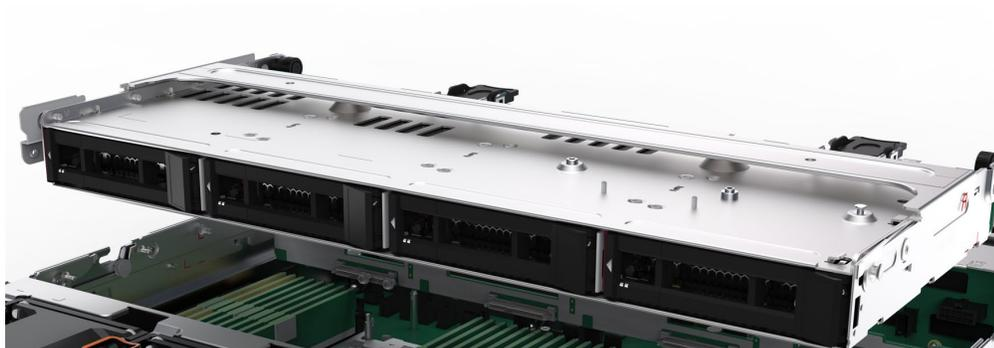
中置8x2.5英寸热插拔硬盘托架
