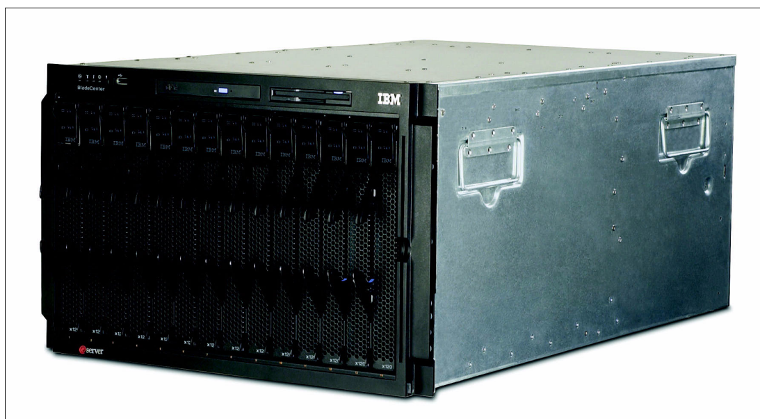
図 1-1 最大 14 台のサーバーまたはワークステーションを取り付けることができる BladeCenter E
